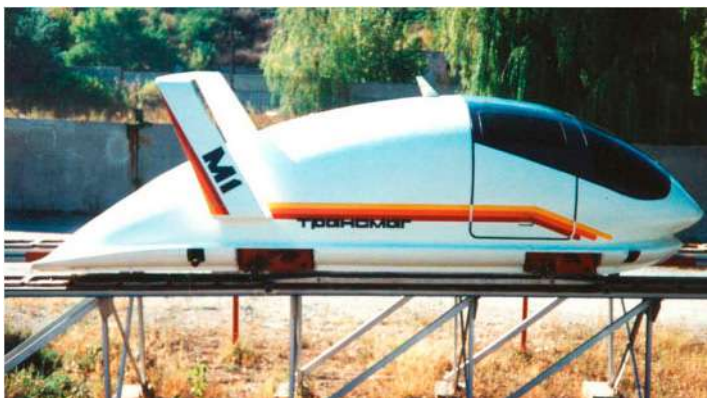
Рис. 1.5. Макет магнітолевітуючого транспортного засобу ІТСТ НАНУ
