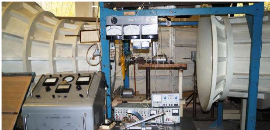
Рис. 2.3. Загальний вид дозвукової аеродинамічної труби Т-5 в аеродинамічній лабораторії ДНУ
